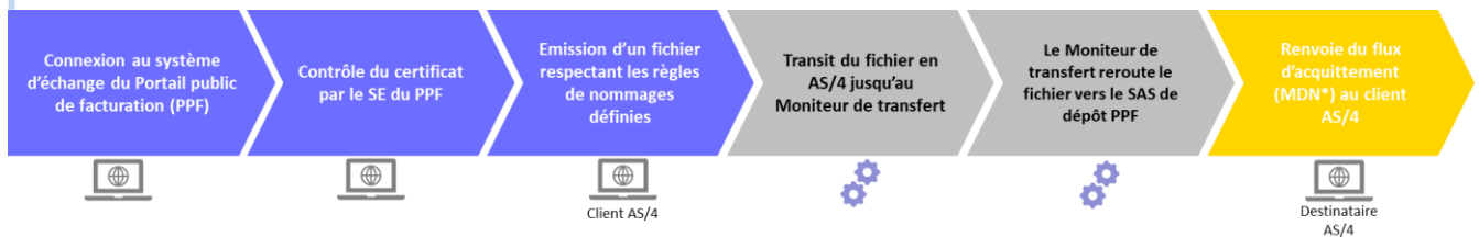
Figure 78 : Schéma d'un circuit aller d'un transfert par protocole AS/4
