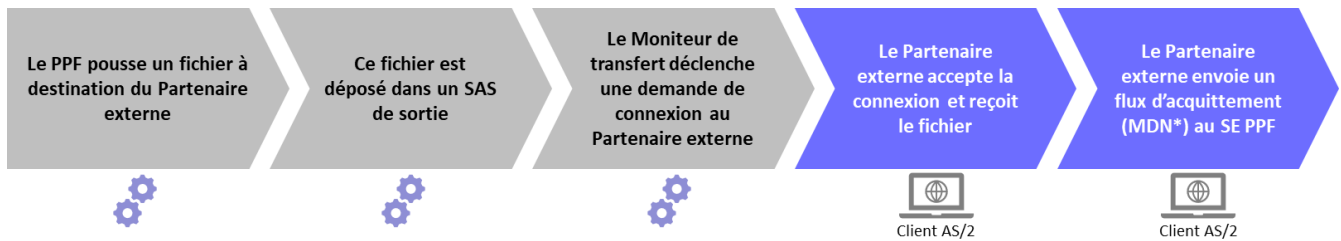
Figure 77 : Schéma d'un circuit retour d'un transfert par protocole AS/2
