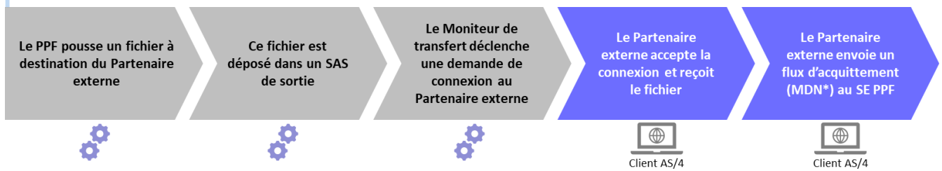
Figure 79 : Schéma d'un circuit retour d'un transfert par protocole AS/4
