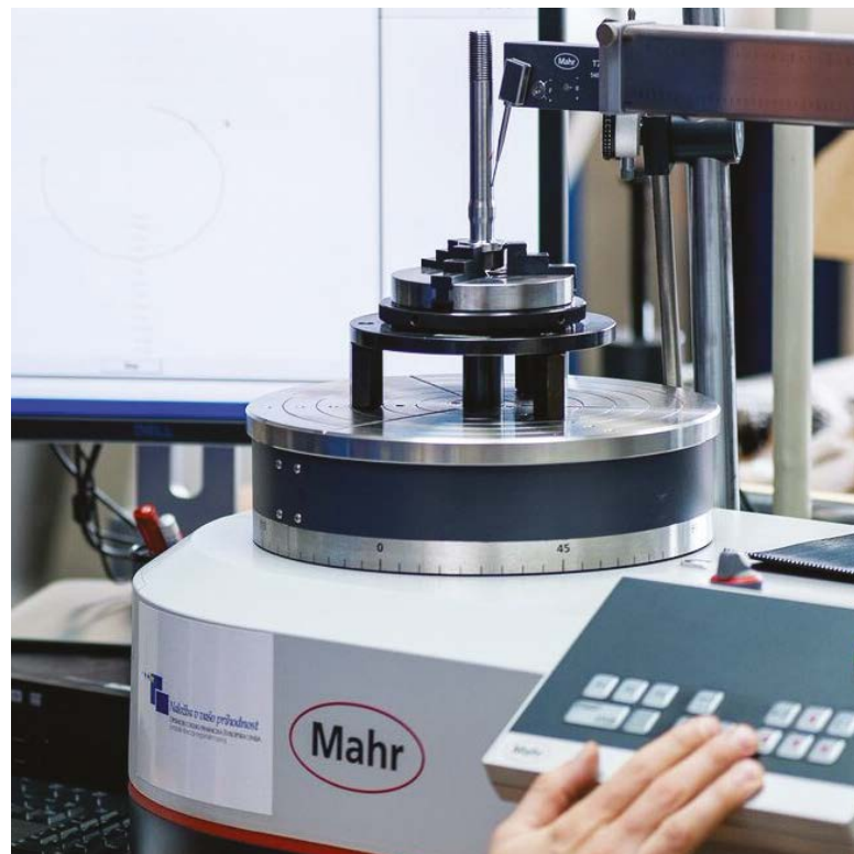
Kontrola dimenzij in položajnih toleranc z merilnim strojem MAHR.
