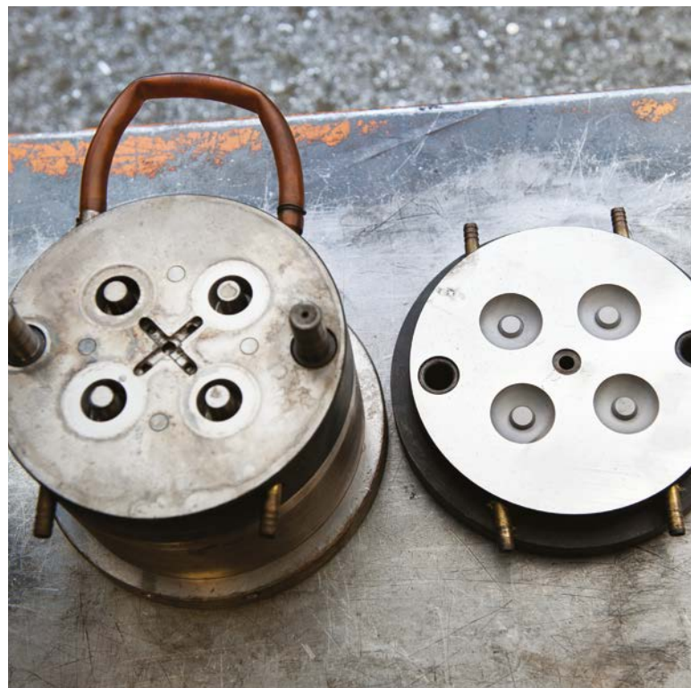
Orodje namenjeno prvemu izdelku Polycoma - higienski ugaševalnik cigaret
